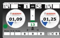
**PC-Anbindung:** „BPS-TV“ übermittelt die Daten direkt an den Windows 10 PC oder Laptop. Bremskraft, Differenz und weitere Werte werden klar und gut ablesbar dargestellt
